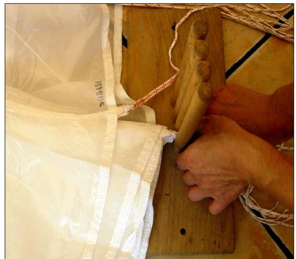
4 – Une fois l'ensemble des panneaux placés à gauche ou à droite, séparer les panneaux et les suspentes en 2 groupes symétriques (même nombre de chaque côté)
