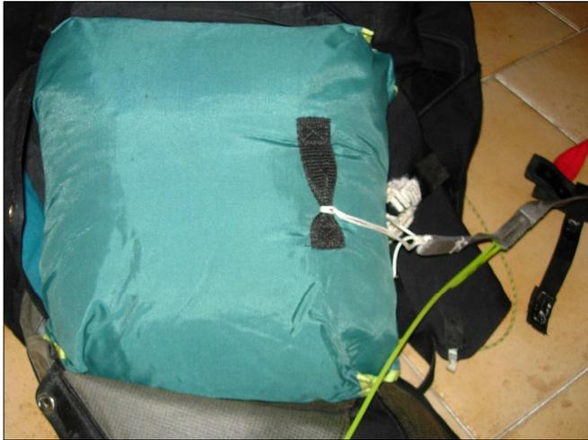
20 – Fermez le container en utilisant à nouveau un morceau de suspente (ou un morceau de fil de fer souple et fin) pour faire passer les anneaux en cordelette au travers des œillets de fermeture du container
