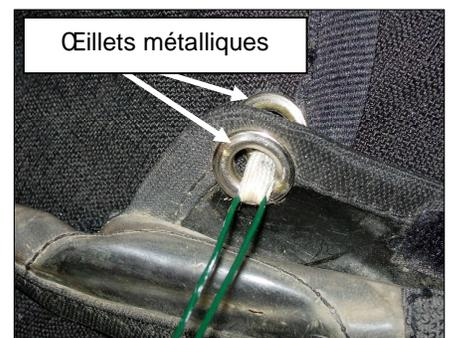
Contrairement à la suspente, le fil de fer souple et fin ne génère aucun échauffement quand il est retiré de l'anneau en cordelette
