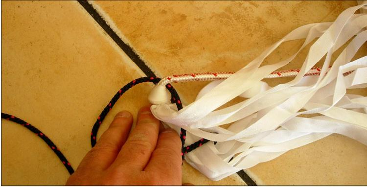
**6 – Au niveau du raccordement [suspente / sangles] vérifiez la bonne séparation des suspentes gauches et droites – suspente d’apex au centre**
